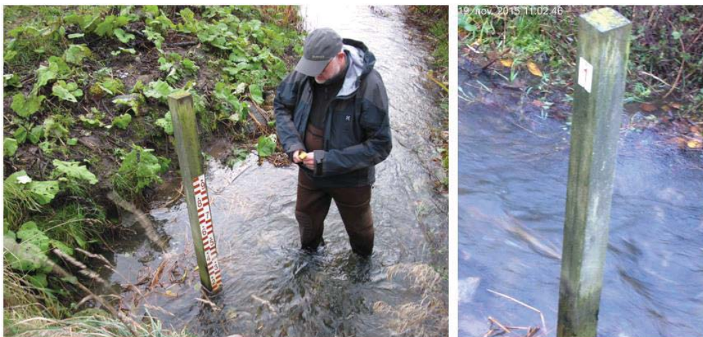
Figur 20: Ved Skalapæl 1, 115 meter opstrøms forsøget var der meget varierende strømforhold omkring skalapælen, og aflæsningerne af denne skala skønnes mere at være et udtryk for strømforhold end for påvirkninger af forsøget.
