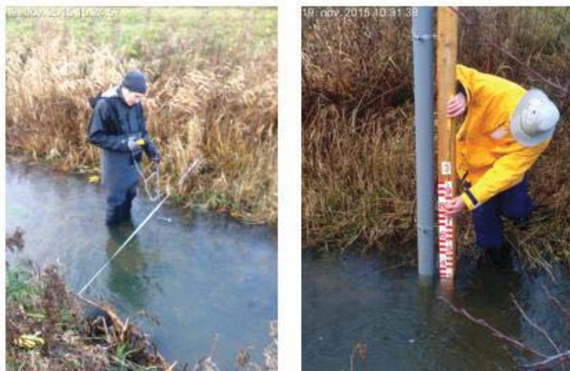
Figur 6: Vandføring måles med vingeinstrument umiddelbart inden forsøget går i gang og vandspejl aflæses ved alle skalapæle.
